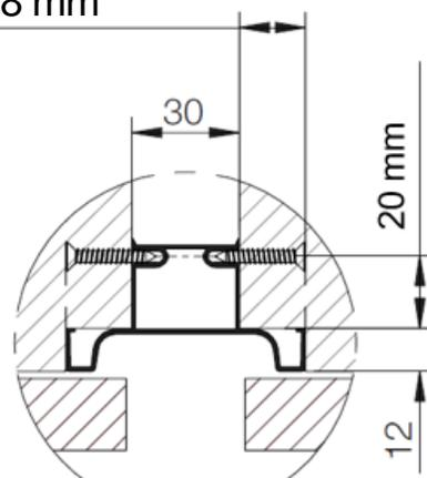
вариант скрытого монтажа боковины шкафа
