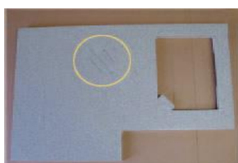
(1) Трещины от горячей посуды
