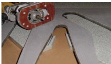
(8) Вырезание поврежденного выступа
