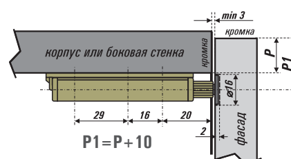
при скрытом монтаже - фиксатор в полости плиты
